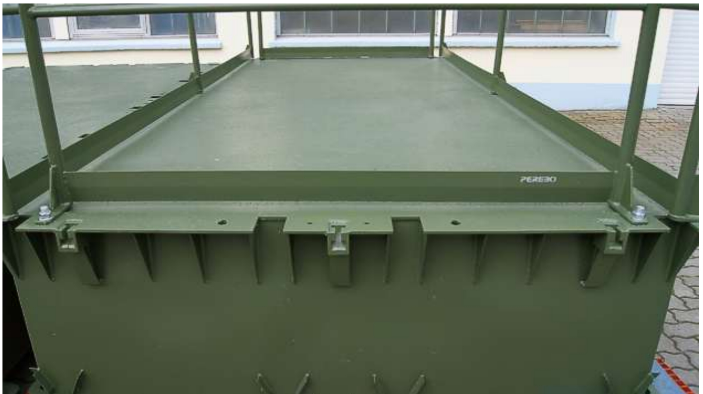
PSK-10 mit umlaufendem Geländer
